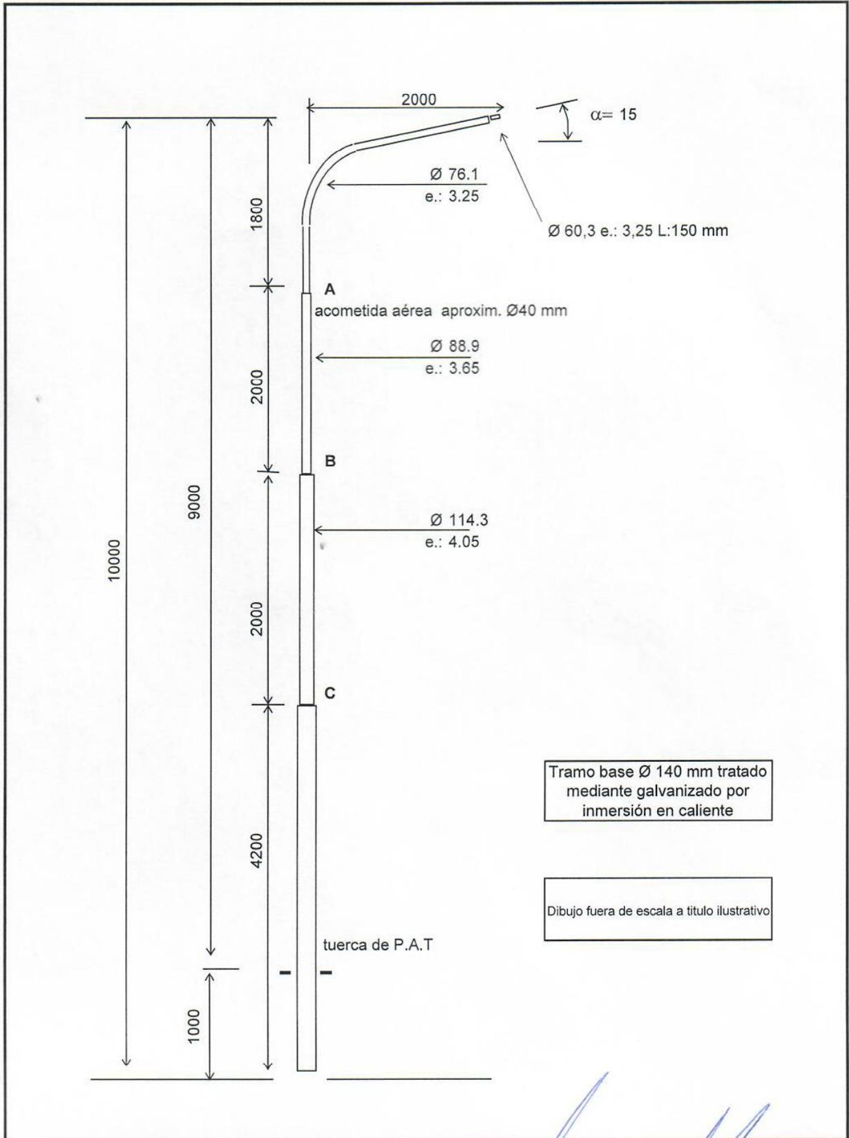
Tramo base  $\varnothing 140$  mm tratado mediante galvanizado por inmersión en caliente
