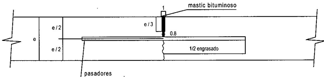
**LONGITUDINAL DE CONSTRUCCIÓN TIPO "D"**
