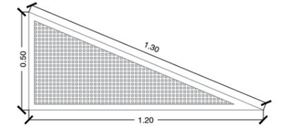
PIEZA 2 | 0,50x1,20x1,30m - Espesor 6cm
