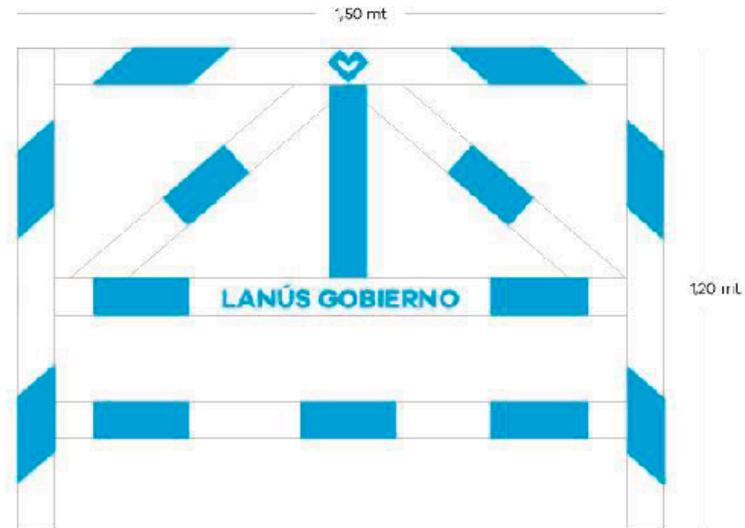
El presente es un modelo de valla de obra tipo. El diseño final será enviado mediante correo electrónico por parte de la Inspección.
