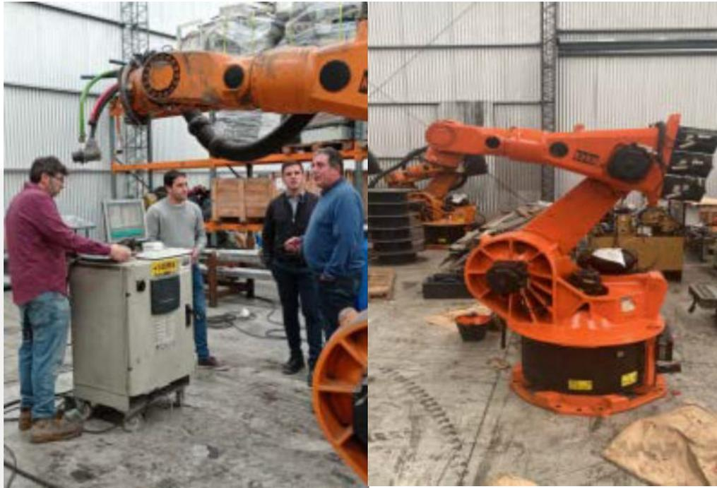
UN (1) robot KRC1, que contará con herramientas de soldadura, pick and place y handling.
